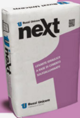
**Next clinker** è un legante idraulico a base di clinker solfoalluminato ottenuto mediante la cottura di una miscela di bauxite, gesso e calcare ad una temperatura di circa 1.350° C e la successiva macinazione.
